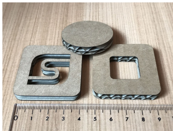
8 - Dvojitá vlnitá lepenka 6,5 mm, F 10 mm/s, Pwr 255
