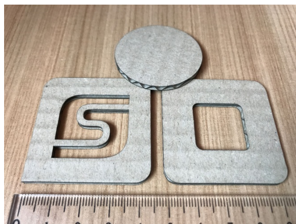
6 - Vlnitá lepenka (tenká) 2,5 mm, F 10 mm/s, Pwr 255
